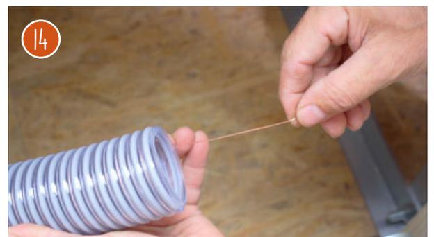
Bereiten Sie den [Pellet Förderschlauch](#) vor, indem Sie die Erdungslitze an beiden Schlauchenden frei legen.
