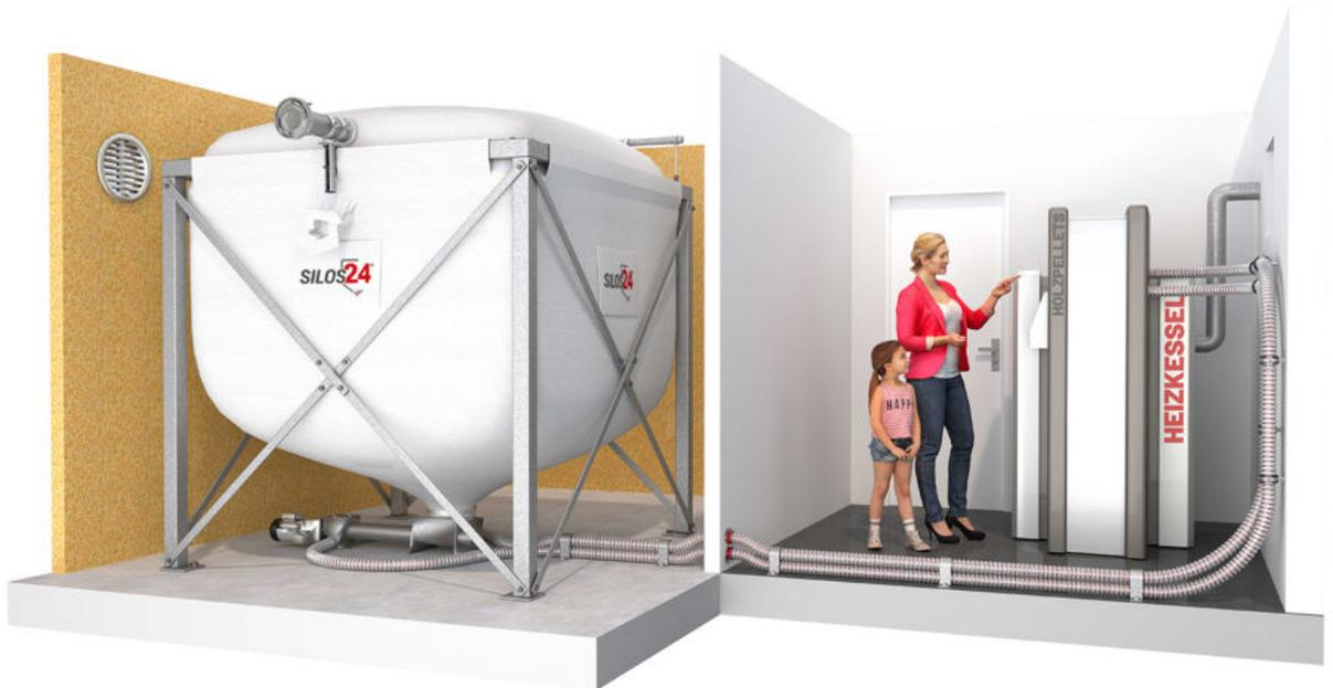
Wesentlich flexibler gestalten Sie die Pelletlagerung mit einem **Saugsystem**, denn das funktioniert ähnlich wie ein Staubsauger: der durch eine elektrisch betriebene Saugturbine erzeugte Sog saugt die Holzpresslinge mit Unterdruck aus dem Pelletlager direkt zum Kessel.
